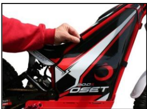
(1.) Lösen Sie die Klettverschlüsse
