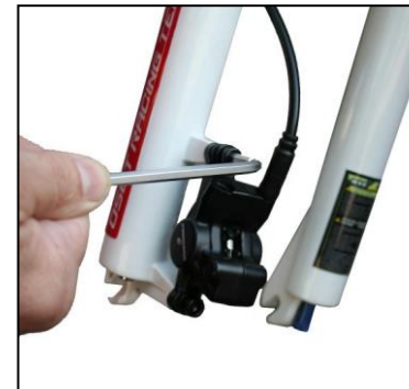
Lösen Sie den Bremssattel.
