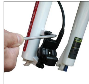
Lösen Sie den Bremssattel.
