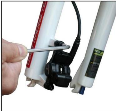
Lösen Sie den Bremssattel.
