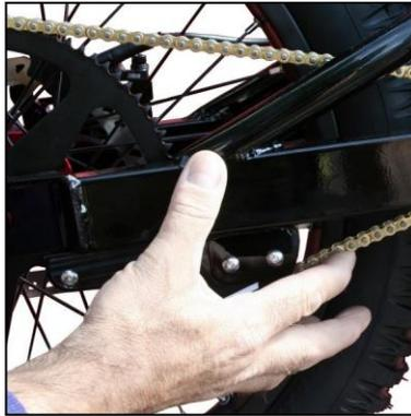
Auf diesen beiden Bildern sehen Sie die richtige Spannung. Wenn der Kettenspanner auf die Kette drückt, sollte sich diese nur 5 bis 10 mm weit bewegen lassen.
