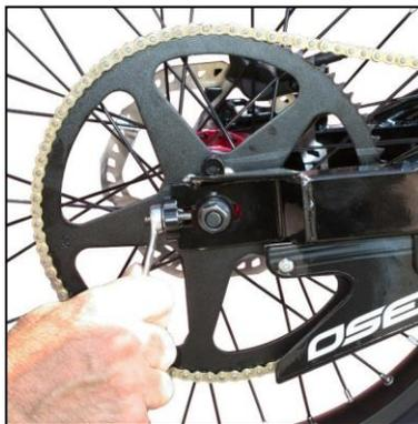
Kettenspannermutter (13 mm)
