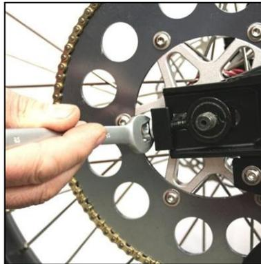
Kettenspannermutter (13 mm)
