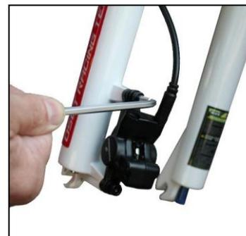
Lösen Sie den Bremssattel.
