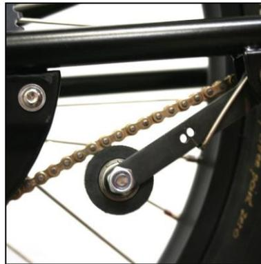
Auf diesen beiden Bildern sehen Sie die richtige Spannung. Wenn der Kettenspanner auf die Kette drückt, sollte sich diese nur 6 bis 16 mm weit bewegen lassen.
